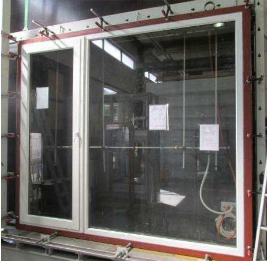
Bild 1 Probekörperansicht auf Prüfstand Fenster geschlossen
